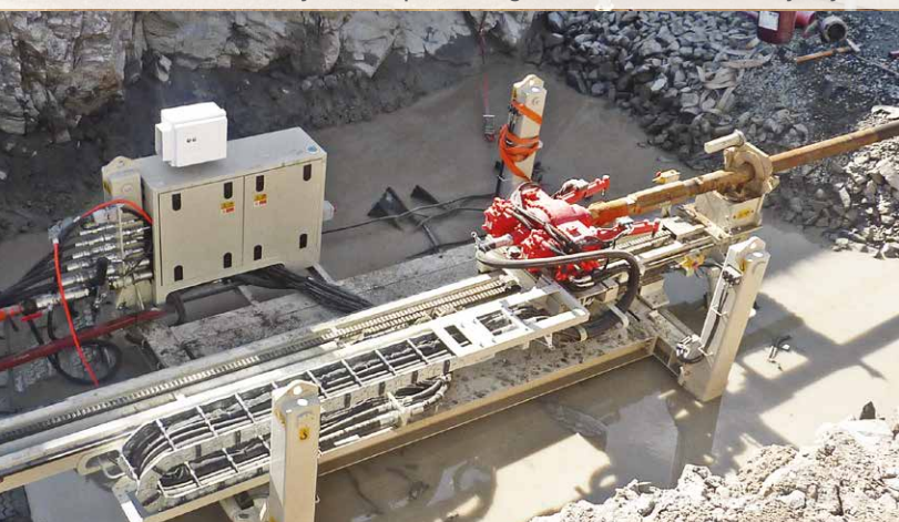
Perforatrice speciale su skid per perforazioni orizzontali Montowana na ramie wiertnica specjalna do wiercenia poziomego.
