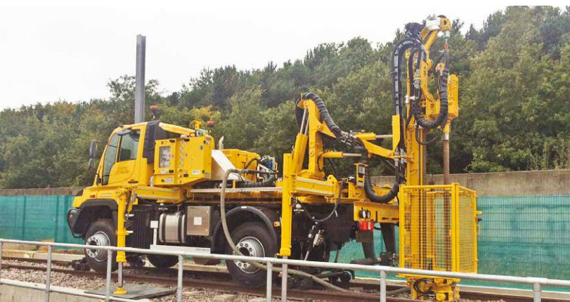
Perforatrice speciale su camion per lavori di consolidamento e sondaggi su tracciati ferroviari
