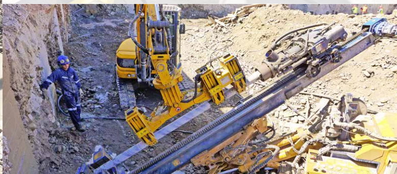
Manipolatore per aste e rivestimenti CPH Podajnik/manipulator do rur płuczkowych i okładzinowych CPH.
