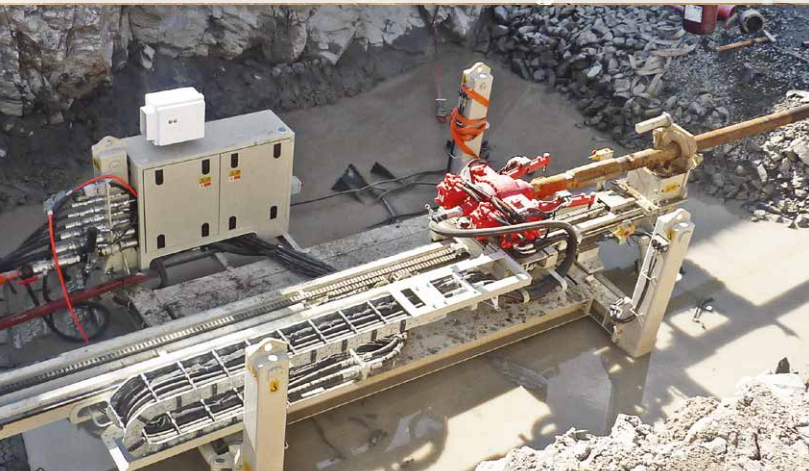
Perforatrice speciale su skid per perforazioni orizzontali Special skid mounted drill rig for horizontal drilling
